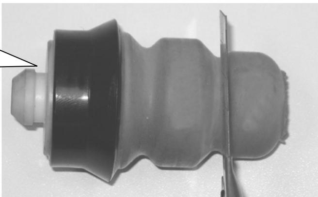
Mitgelieferte Höhenverstellung wird ohne Gummiunterlage zwischen Karosserie und oberem Federende montiert.
